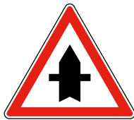
AB2 Intersection avec une route dont les usagers doivent céder le passage dans le cas où un panneau AB6 ne peut être utilisé
